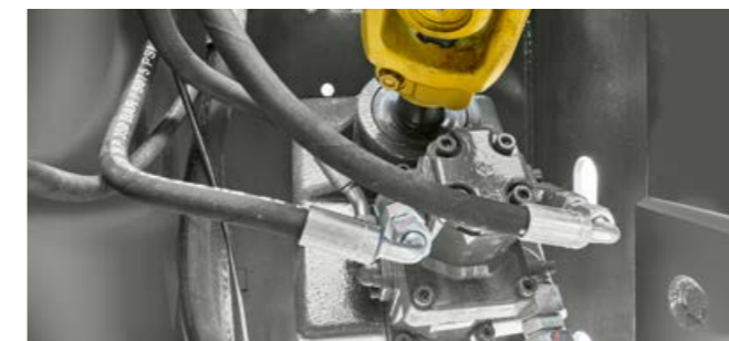
Zwei Ölpumpen versorgen das Eingangsgetriebe und das Knoterreinigungssystem TURBO FAN mit Hydrauliköl.
