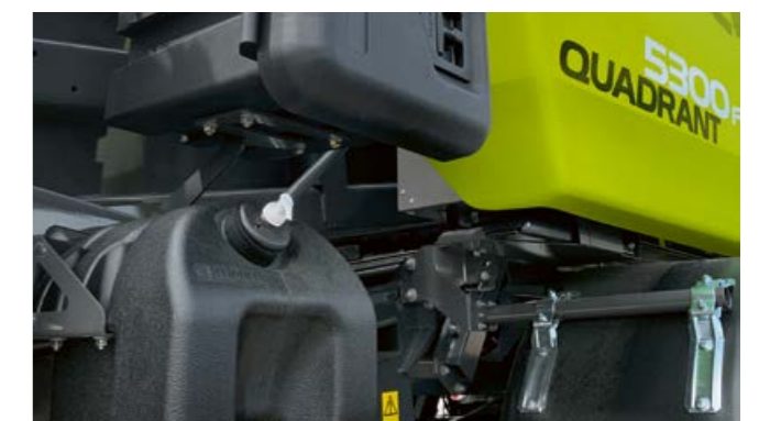
Großer Wassertank (18 Liter) mit integriertem Seifenspender.
