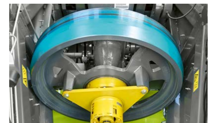
Die neue Schwungradversion: Erhöhte Masse und Trägheit für eine verbesserte Wirkung.
